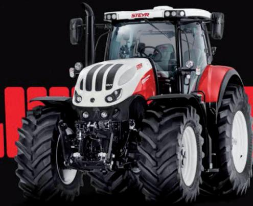
2 Modelle mit 271 und 300 PS Nennleistung und stufenlosem CVT-Doppelkupplungsgetriebe.
