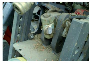
Ein Haarriss am Oberlenker kann frühzeitig erkannt und so rechtzeitig getauscht werden. Zum Verhängnis kann solch ein Schaden im Straßenverkehr oder bei Instandsetzungsarbeiten werden.
