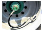
sie auch. Durch die große Bereifung auf den Güllewagen wird das Gewicht auf eine möglichst große Fläche verteilt. Die modernsten Modelle können mittlerweile sogar den Luftdruck während der Fahrt daran anpassen, ob sie auf der Straße oder auf dem Feld sind. Auf den Feldern wird der Luftdruck in den Reifen abgesenkt – das Foto zeigt eine Regelanlage –, um die Auflagefläche der Reifen zu erhöhen und damit den Bodendruck zu vermindern.
