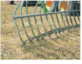
wendung von modernen Ausbringmethoden wie Schleppschläuchen führt zu deutlich geringeren Geruchsbelästigungen, weil die Gülle unmittelbar in den Pflanzenbestand eingebracht wird. Im Sommer wird die Gülle entweder direkt im Rahmen der Ausbringung oder kurz danach auf den Ackerflächen eingearbeitet. Danach ist die Gülle meistens gar nicht mehr zu riechen.
