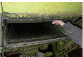
Bei der Instandsetzung ist auf scharfe Teile zu achten. Die Maschine ist dabei unbedingt still zu setzen (arretieren) und es sind geeignete Handschuhe sind zu tragen.
