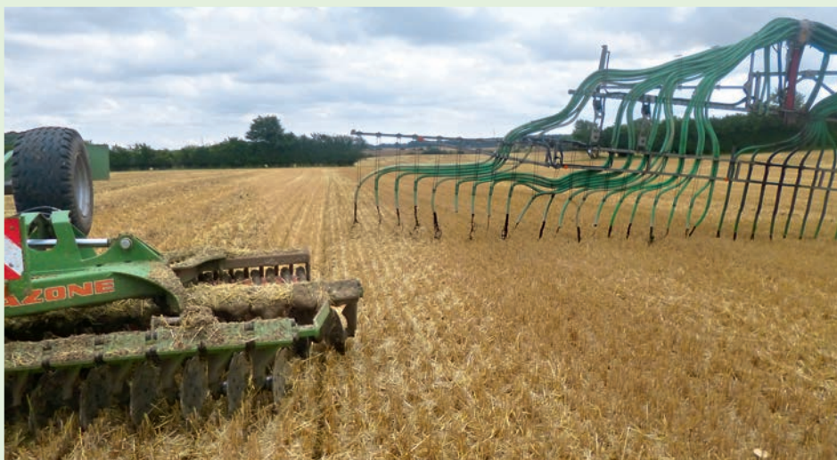
Einarbeitung von Gülle bzw. Gärresten mit einer Scheibenegge direkt hinter dem Ausbringfahrzeug. Foto: J. Scherrer
