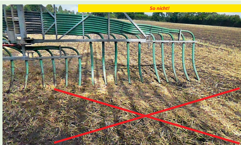
Überlappung bei der Ausbringung mit einem Schleppschauchsystem.
