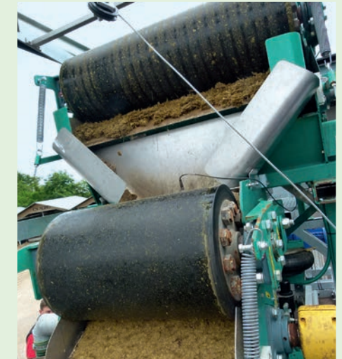
Fest installierter Pressschneckenseparator direkt am Lagerbehälter und mobiler Walzenseparator.
