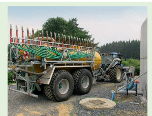
Ausbringfahrzeug holt Gülle/Gärreste selbst vom Behälter. Foto: Zunhammer
