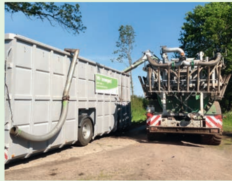
Übergabe vom Zubringer-LKW an einen Feldrandcontainer und Abholung durch ein Ausbringfahrzeug. Foto: P. Hartmann
