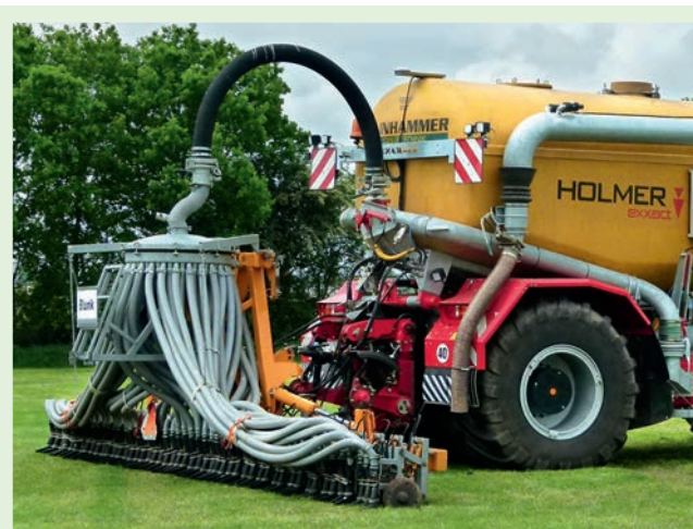
Schlitzgerät für die Ausbringung von Gülle oder Gärresten über einen Schlitz in den Boden.
