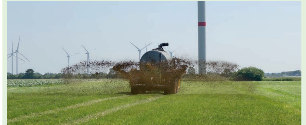
Ausbringung mit einem Möscha-Verteiler auf eine Grünlandnarbe. Dieses Ausbringverfahren ist bei hohen Außentemperaturen mit ähnlich hohen Ausbringverlusten verbunden, wie die anderen Breitverteilungssysteme und deswegen nicht empfehlenswert. Foto: F. Steinmann
