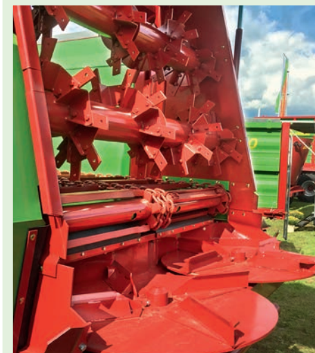
Streuwerk eines Miststreuers und Festmistausbringung auf Maisstoppeln mit Untersaat.
