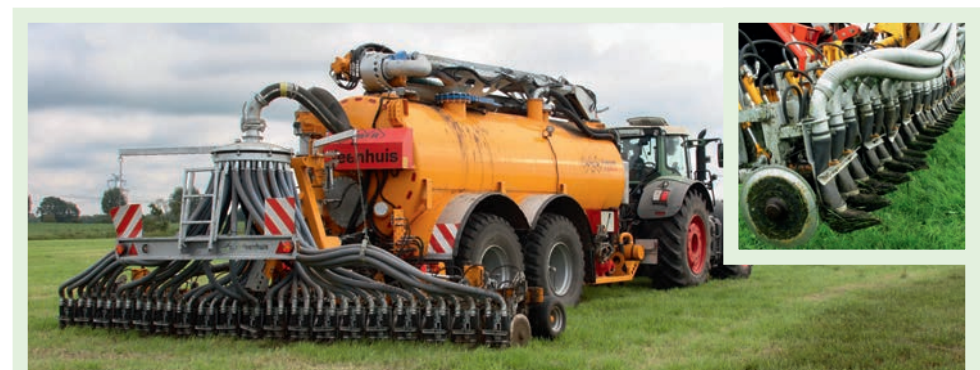
Güllewagen mit Schlitzgerät beim Schlitzen (links). Schlitzgerät ausgehoben (rechts).
