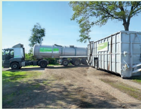
Übergabe vom Zubringer-LKW an einen Feldrandcontainer und Abholung durch ein Ausbringfahrzeug. Foto: P. Hartmann
