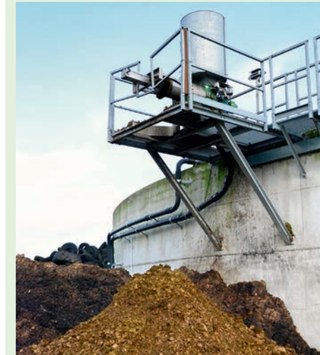
Fest installierter Pressschneckenseparator direkt am Lagerbehälter und mobiler Walzenseparator.
