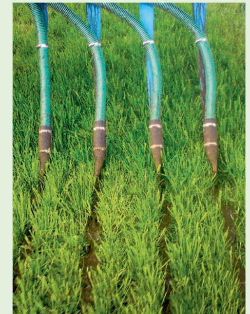
Gülle in Getreidestoppeln mit Untersaat geschlitzt und in eine Grünlandnarbe per Schleppschuh eingebracht. Foto: F. Steinmann links und rechts S. Jensen
