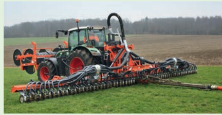
Ausbringung mit einem Schleppschauchgestänge auf Raps, das durch Verschlauchungstechnik versorgt wird (links). Schlitzgerät in Kombination mit Verschlauchungstechnik auf Grünland (rechts). Foto: H. Thomsen
