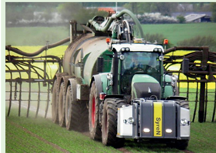
Gülleausbringung mit einem Gülleensäuerungssystem.
