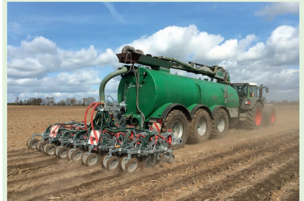
Gülle bzw. Gärrestausbringung mit einem Strip-Till-Gerät.
