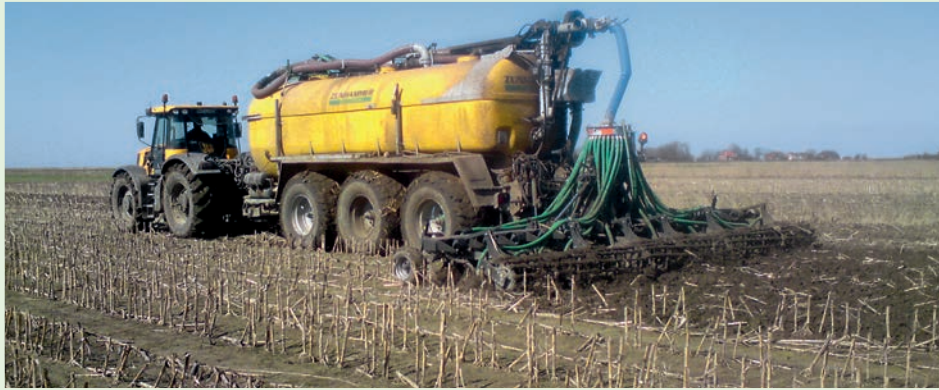
Direkte Einarbeitung von Gülle bzw. Gärresten mit dem Ausbringfahrzeug auf Maisstoppeln im Frühjahr. Foto: S. Jensen
