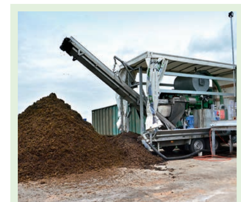
Mobiler Pressschneckenseparator auf einem Autoanhänger.
