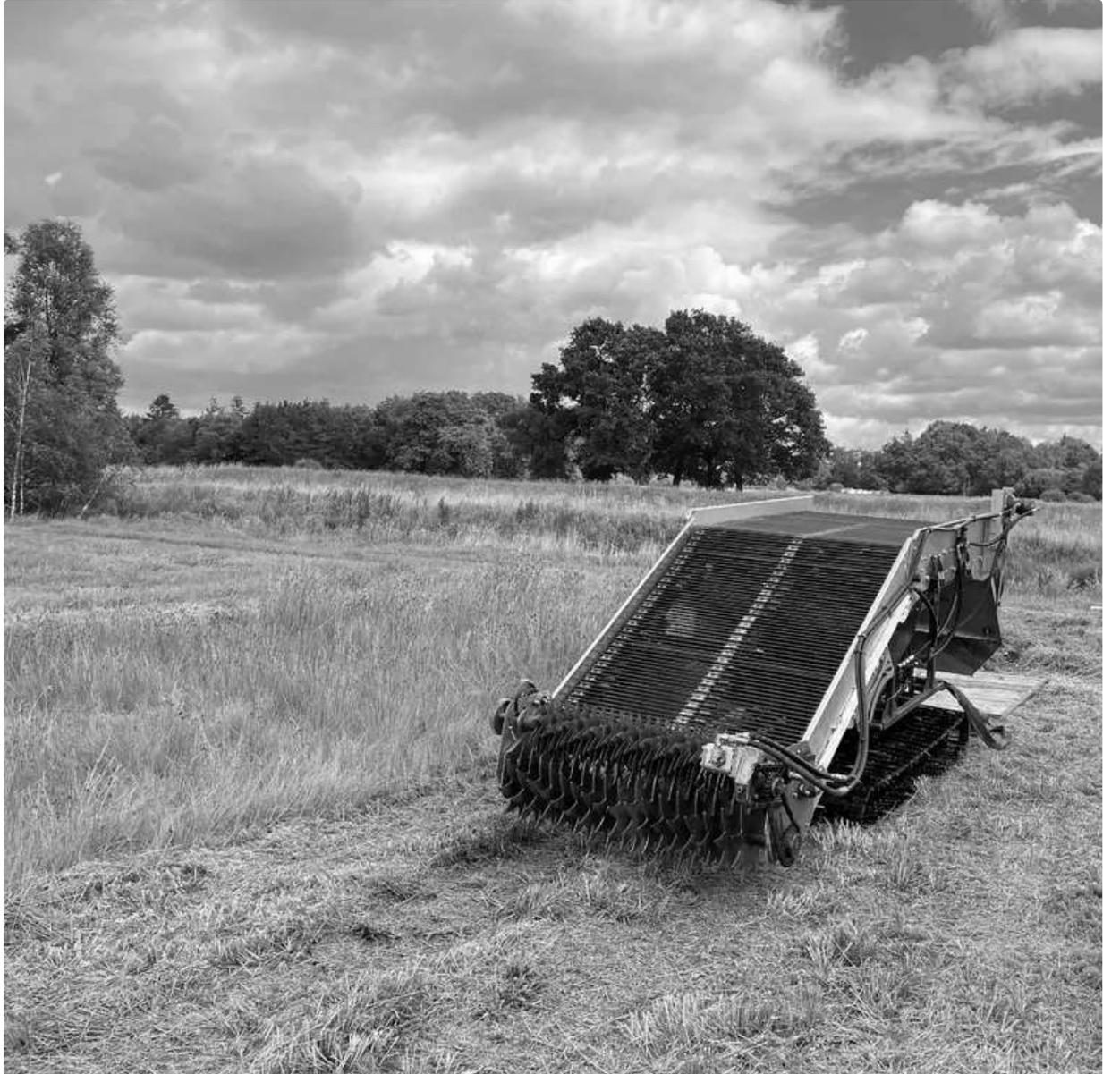
*Ein umgebauter Pistenbulle von Mera-Rabeler soll das Torfmoos vertikutieren. Dank niedrigem Bodendruck braucht er keine Fahrdämme, sondern kann direkt über die Fläche fahren. (Bildquelle: Mera-Rabeler)*
