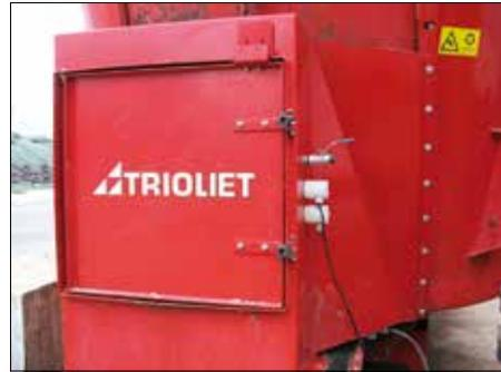
*Revisionsöffnung, bei deren Öffnung die mechanischen Teile im Feststoffdosierer stillgesetzt werden*
